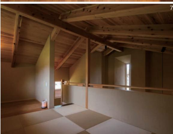
1・5・6メインとなる1階の空間。冬の寒さ対策として、土壁に加えて断熱材のセルローズファイバー、床暖房を採用している。2デスクコーナーに配したピクチャーウィンドウ。3見事な木組。施工は自社大工の田村敦さんが担当した。4ムラなく塗られた土壁。「生活しやすいように角の面を大きくしました」(加村さん)。72階和室。8土壁のサンプル。
